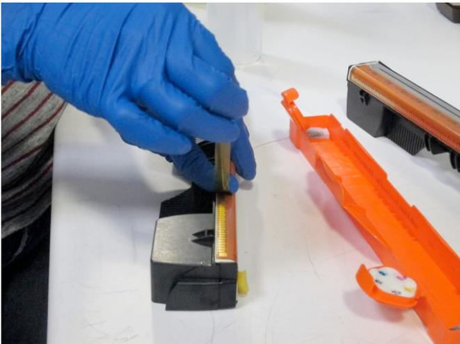
3. Setzen Sie den Druckkopf in der orangenen Schutzabdeckung ein.
