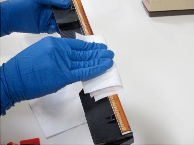
2. Kleben Sie die Nozzle und Konnektor Schutzstreifen wieder auf dem Druckkopf.
