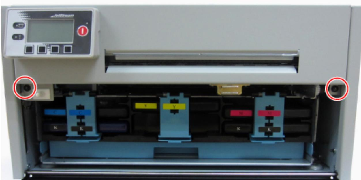
Anschließend müssen 4 weitere Schrauben hinten am Frontpanel entfernt werden :
