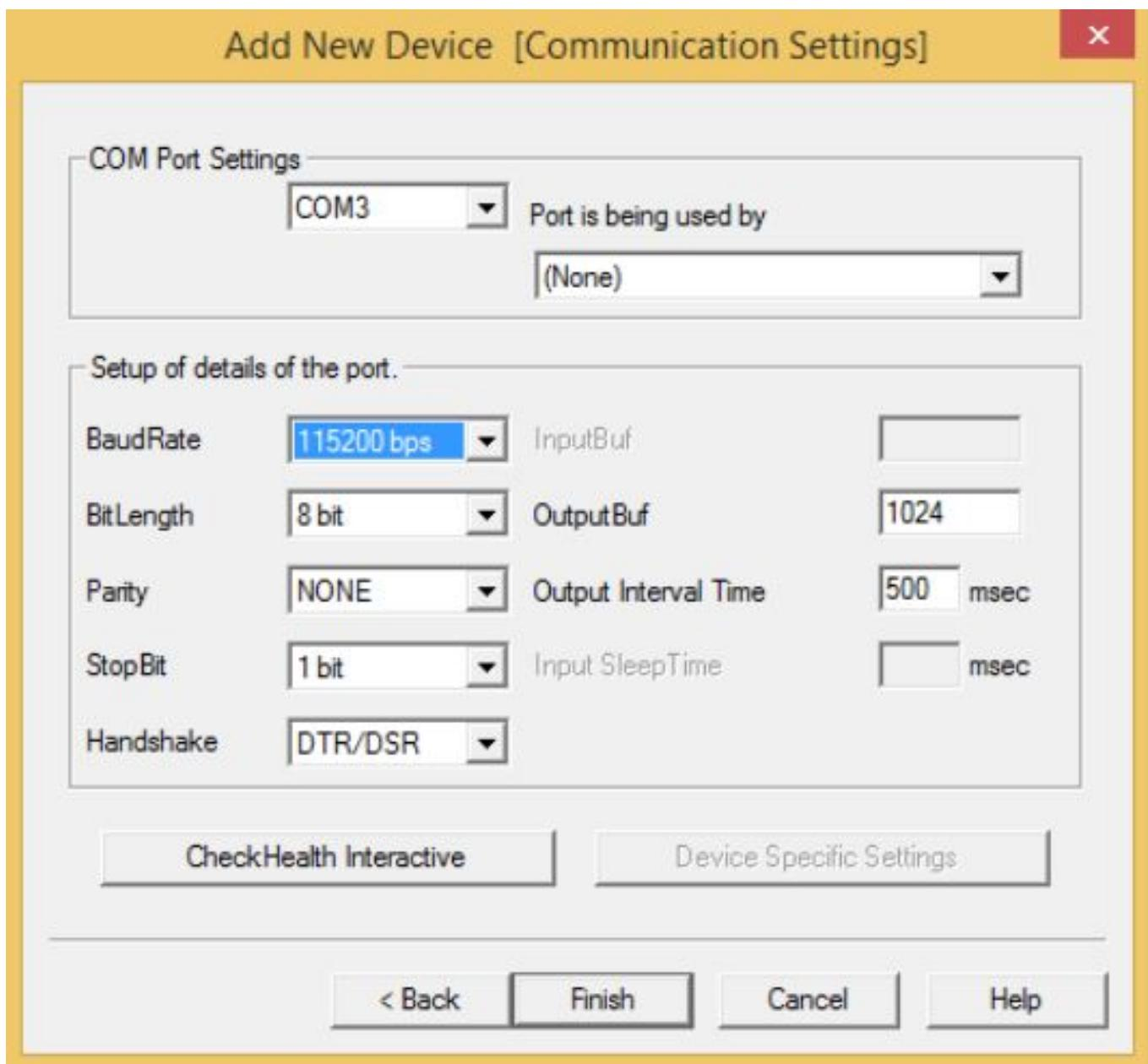
Das Display muss am Gerät direkt über die Dip Switches auf die Bautrate 115200 eingestellt sein!
