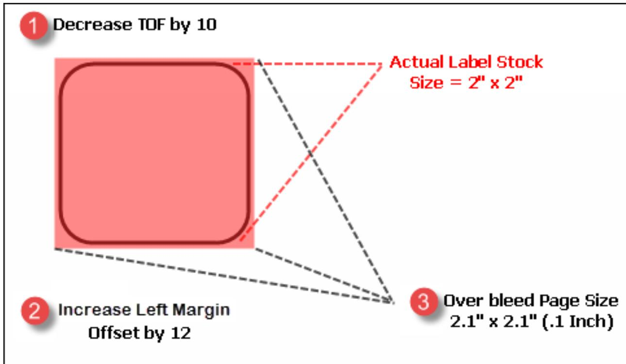
Verringern Sie die Top of Form um 10. Dies führt dazu, dass der Drucker den Druck vor dem Etikett beginnt und gewährleistet so ein voll bedrucktes Etikett.
