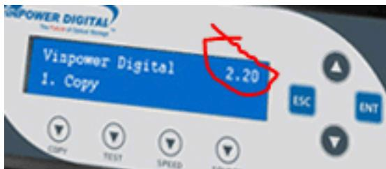
Das können Sie einfach checken. Oben im Display sehen Sie rechts die Firmware. Wenn dort eine 3 steht, ist das Firmware update durchzuführen. Bei einer 2.xx muss ggf. der Controller ausgetauscht werden.
