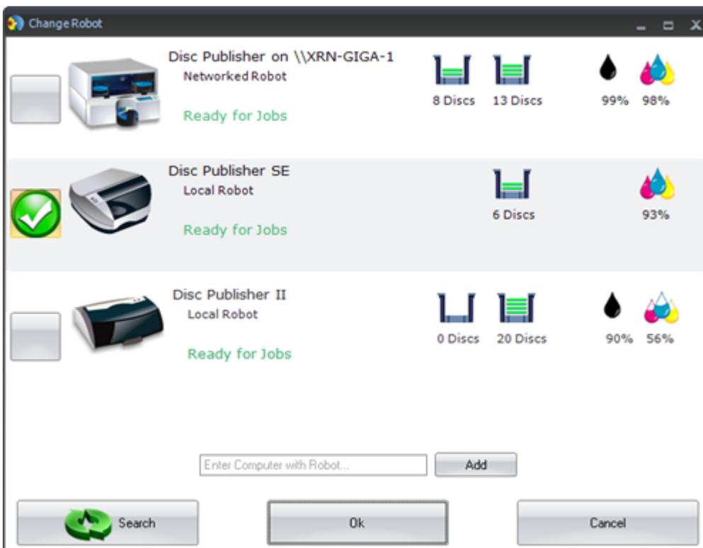
4. Falls ein Roboter gerade erst zum System hinzu gefügt werde erscheint er manchmal nicht sofort in dieser Liste. Klicken Sie auf „Suchen“. Hilft das nicht, beenden Sie PTPublisher und verbinden den Roboter nochmals mit einer anderen USB Schnittstelle, oder der selben nochmals. Starten Sie dann PTPublisher. Die Kontrolle sollte aber immer sein, dass in der Systemsteuerung → Drucker alle Geräte zu sehen sind und im Zustand „Bereit“ stehen. Erst dann kann PTPublisher die Drucker auch finden.
